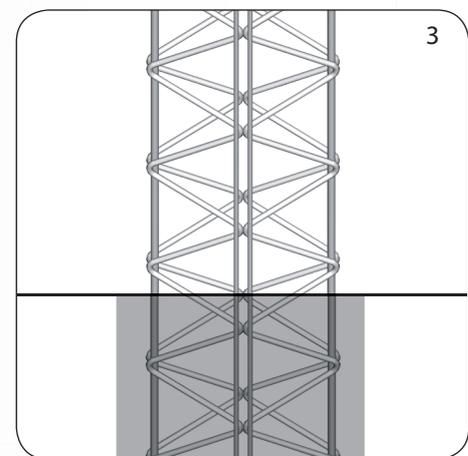
Vordere Gittermatte durch Einhängen der Querstreben (kürzerer Biegung) fixieren und mittels Universalklemmen befestigen (13mm Steckschlüssel).
