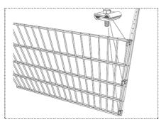
Verbinden Sie ein 230cm Gittermatten-Innenelement mit einem 100cm Gittermatten-Innenelement im rechten Winkel (90°) mit drei Verbindungsklemmen (L-Form) und ziehen Sie diese vorerst nur handfest an.
