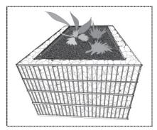
Zur Befüllung der Hochbeetwände verwenden Sie bitte ein Schottermaterial Ihrer Wahl (vorzugsweise: Korngröße 32/45). Vor dem Auffüllen des Innenraums legen Sie bitte mindestens eine 0,2mm PE-Folie als Trennung zwischen dem Schottermaterial und der Innenraumfüllung (Pflanzerde, Mulch, etc.)
