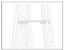
Hängen Sie nun die Querstreben gleichmäßig verteilt zwischen der äußeren und der inneren Gittermatte ein.
