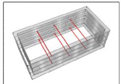
Hängen Sie nun die inneren Verbindungs-Querstreben zur Aussteifung gleichmäßig verteilt in den Innenbereich. Anschließend das Hochbeet im rechten Winkel ausrichten und die Verbindungsklemmen fest anziehen.
